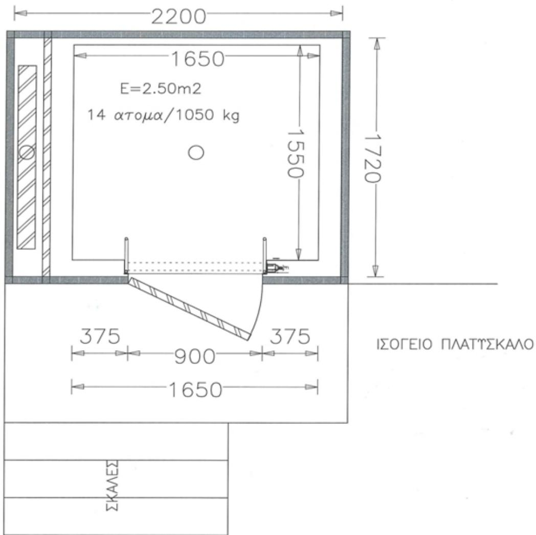
Ο ανελκυστήρας θα χρησιμοποιεί δικό του ανεξάρτητο κινητήριο μηχανισμό, εγκατεστημένο στο μηχανοστάσιο αυτού το οποίο βρίσκεται στο ανω μέρος του φρέατος στο δώμα, και θα αποτελείται,
